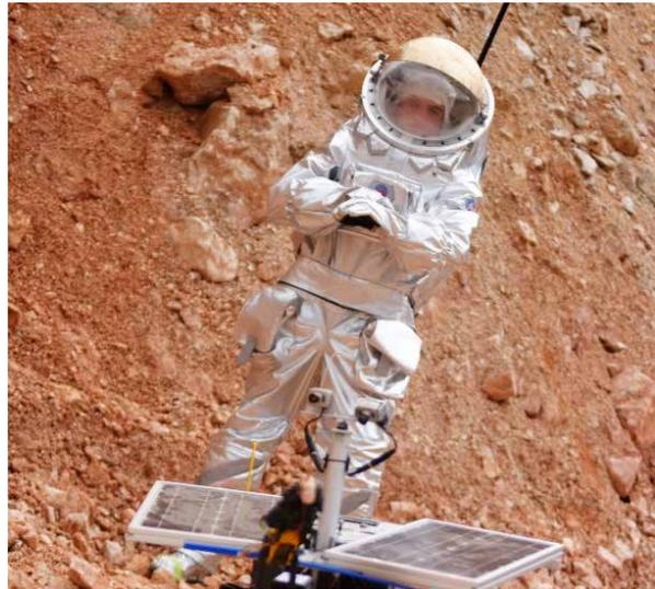
klappbaren Visier gegen die aggressive UV-Strahlung der Sonne versehen ist. Meist im Rumpfbereich befinden sich die Anschlüsse für Sauerstoff, Abluft, Kühlwasser und Kommunikationssysteme.<sup>19</sup>
